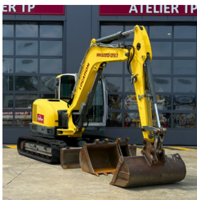
PELLE 8T ÉQUIPÉE BROTEC WACKER NEUSON EZ80 FILTRATION POUR TRAVAIL EN MILIEU AMIANTIFÈRE
