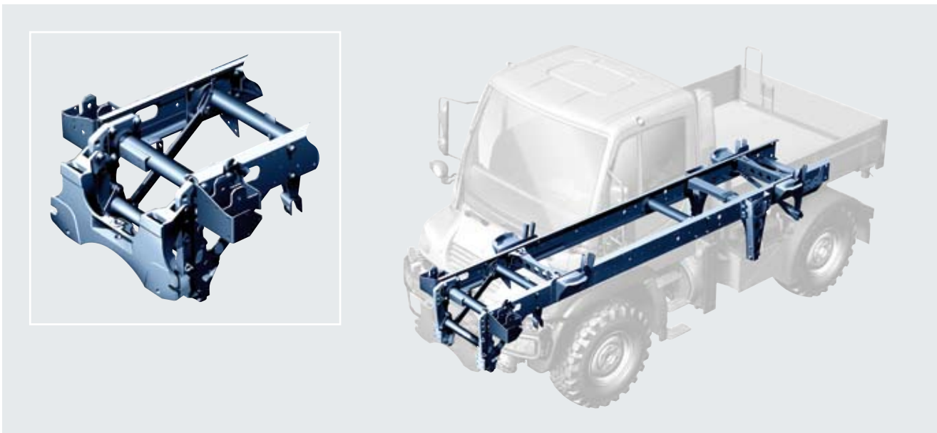
Le cadre en échelle continu et solide avec supports de fixation intégrés facilite la fixation directe d'outils à moindres frais.
