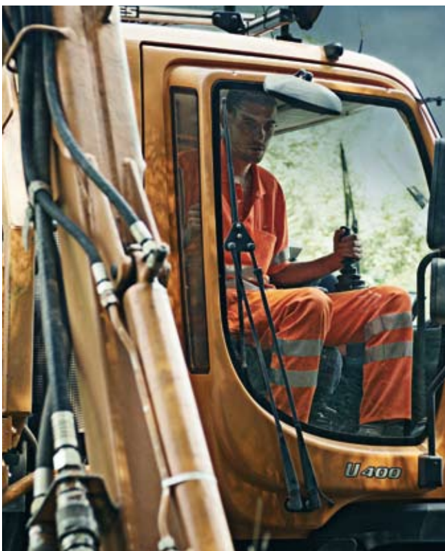
Porte de fauchage et siège pivotant, pour une visibilité optimale et un espace généreux au niveau des jambes.
