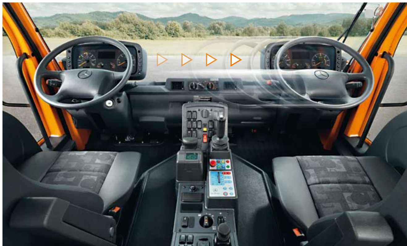
En un tour de main, vous pouvez déplacer le poste de conduite VarioPilot® de la gauche vers la droite – une solution idéale pour un mode de fonctionnement mono-opérateur à la fois confortable et sûr.
