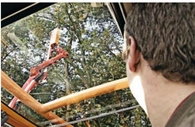
Porte de fauchage et siège pivotant, pour une visibilité optimale et un espace généreux au niveau des jambes.
