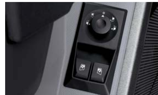
GESTION DES VITRES ET RÉTROVISEURS LATÉRAUX lève-vitres impulsif et réglages des rétroviseurs principaux et grand angle électriques.
