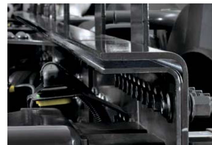
OFFRE ÉLARGIE DE RENFORTS LONGERON pour garantir la résistance mécanique du cadre.
