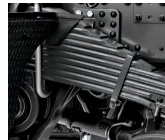
SUSPENSIONS SEMI-ELLIPTIQUES OU PARABOLIQUES 26 t parabolique 3 lames, 32 t semi-elliptique 11 lames, 32 t Xtrem parabolique 4 lames.
