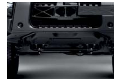
ÉCRAN DE PROTECTION sous le radiateur et la cuvette d'huile.
