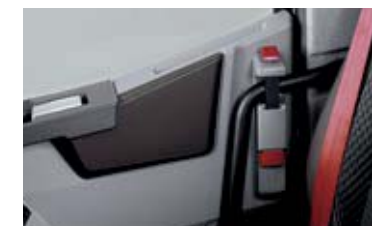
VERROUILLAGE MÉCANIQUE DES PORTES permet une fermeture supplémentaire des portes de l'intérieur du véhicule.
