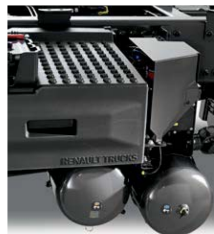
ÉCRANS DE PROTECTION sur les appareils exposés aux chocs : EACU, appareils pneumatiques.
