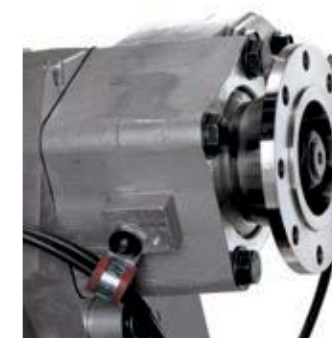
PRISE DE MOUVEMENT pour faire fonctionner les équipements des carrossiers en roulant ou à l'arrêt.
