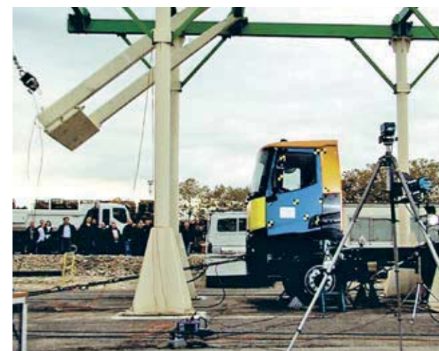
CHOC FRONTAL pour mesurer la résistance de la cabine à l'impact.
