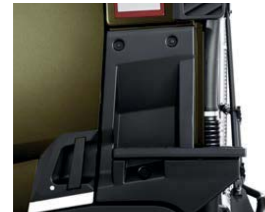
MARCHE LATÉRALE D'ACCÈS À LA CARROSSERIE pour vérifier facilement le contenu du chargement.
