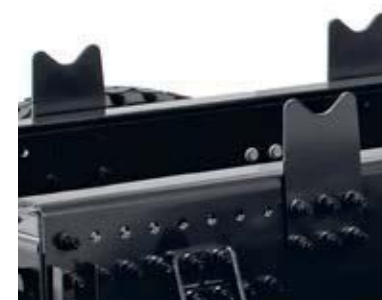
CORBEAUX PLAQUÉS SUR LONGERONS pour faciliter les opérations de carrossage.
