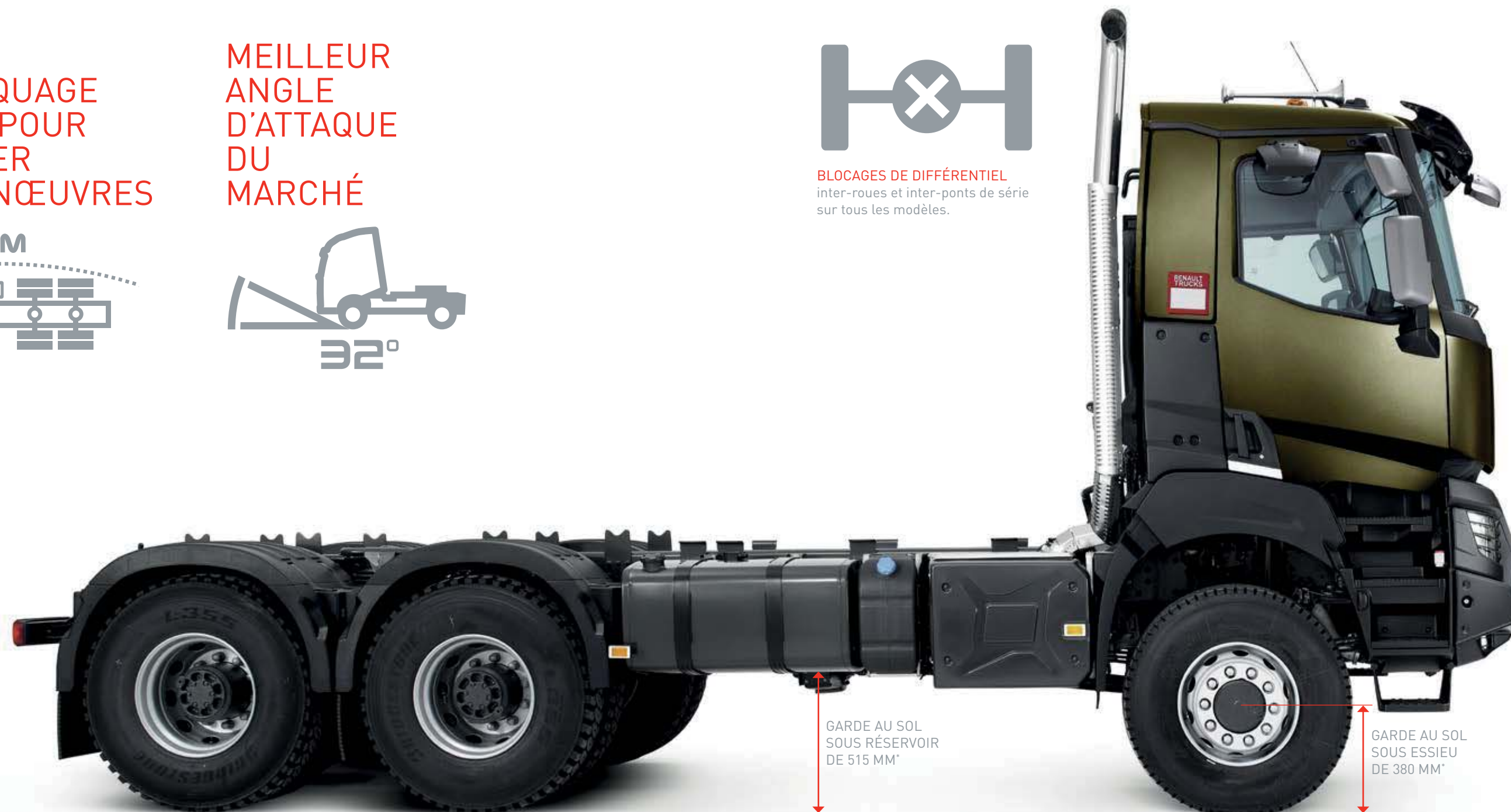
PONT TANDEM À DOUBLE RÉDUCTION pour plus de motricité sur les terrains difficiles.
