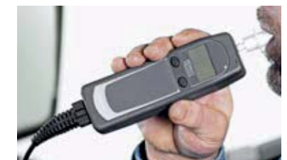
ETHYLOTTEST ANTI-DÉMARRAGE permet un contrôle de l'alcoolémie du conducteur avant le démarrage du véhicule.
