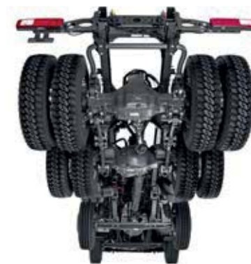
PONT TANDEM À DOUBLE RÉDUCTION pour plus de motricité sur les terrains difficiles.
