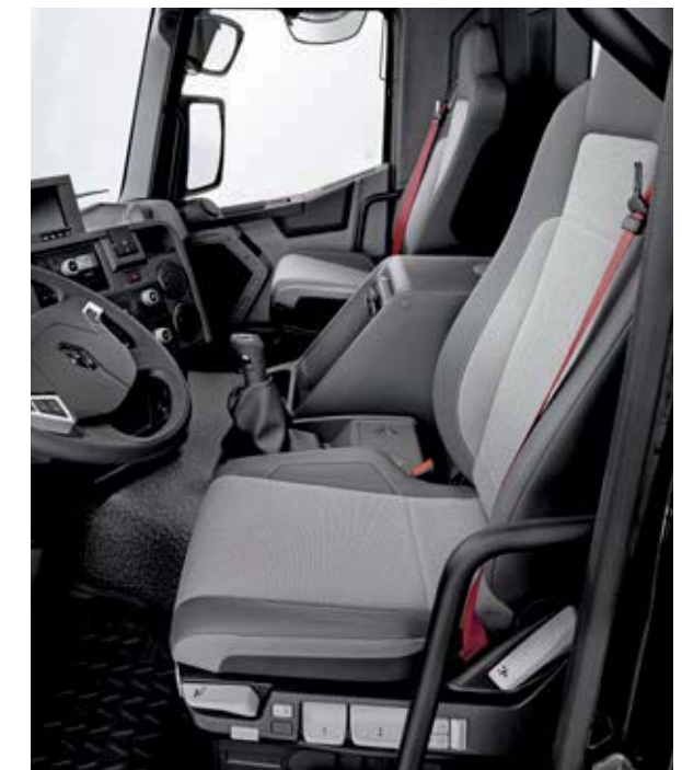
SIÈGES SUSPENDUS VENTILÉS chauffants avec ceintures embarquées, appui-têtes, réglage de soutien latéral et lombaire, plage de recul de 20 cm.
