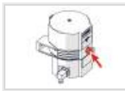
Recharge du système de graissage automatique.
