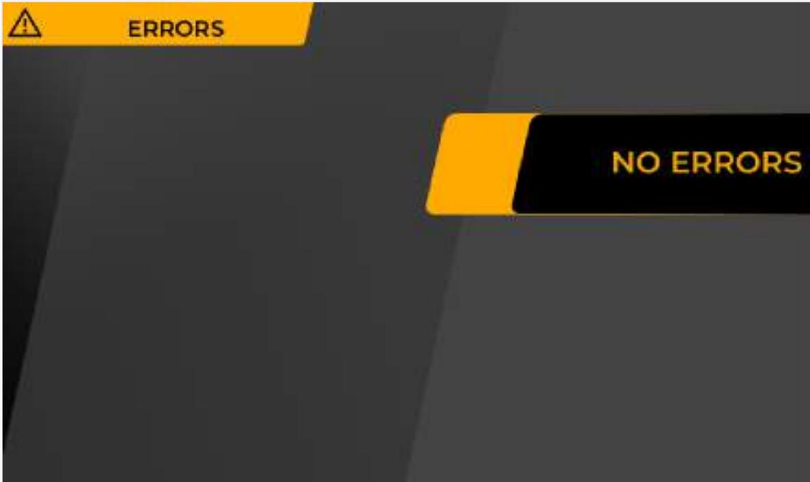
En présence d'erreur, l'icône correspondante (A0), le code d'erreur (A1a) et la description de l'erreur (A1b) sont affichés sur l'écran Home. Un signal sonore est en outre généré pendant 1,5 seconde.
