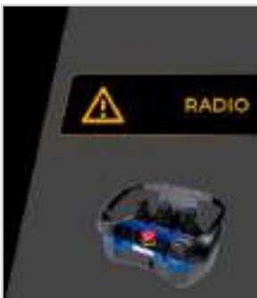
Lorsque le poste de l'opérateur est sur la radiocommande. Ce pop-up avertit l'opérateur de la cabine que les commandes à l'intérieur de la cabine ne sont plus fonctionnelles.
