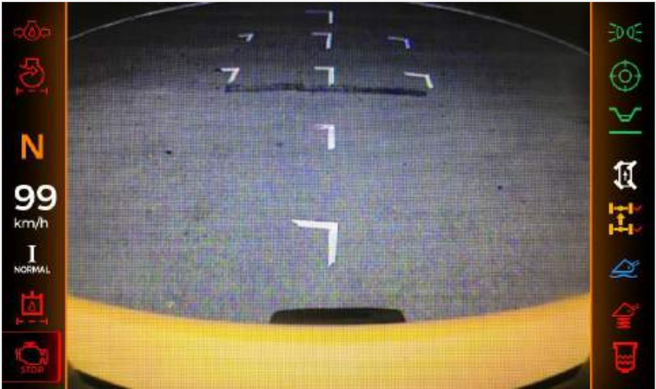
Quand on passe la marche arrière, une alarme sonore intermittente retentit et la caméra (si présente) placée à l'arrière du véhicule s'allume.
