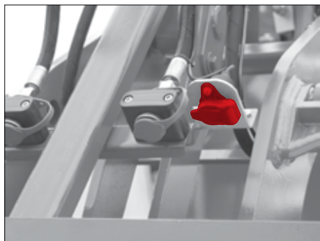
Fig. 50 Prise électrique installée sur la flèche
