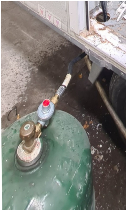
Fermer le robinet de la bouteille Démonter le détendeur et Le ranger dans une boîte de protection
