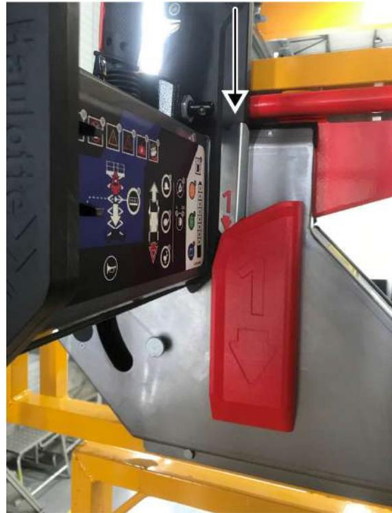
4 - Basculer le pupitre de commandes et l'enclencher dans le repère ( 2 ) du support Activ' Shield Bar Scissor.
