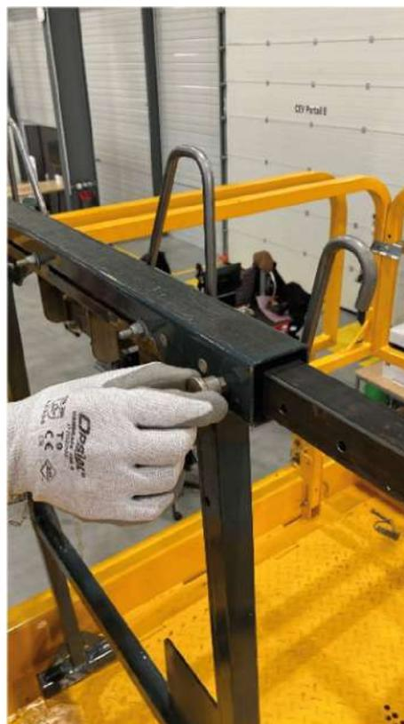
Manipuler l'arrêt de plaque pour le positionner dans différentes positions.
