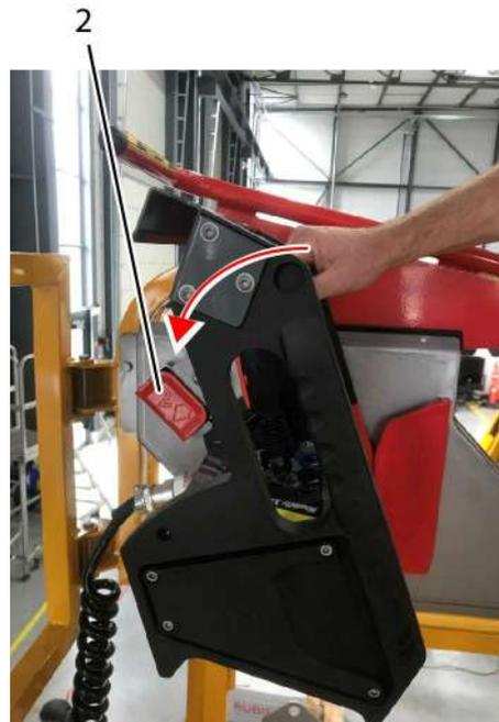
5 - Pour déposer le pupitre, effectuer les opérations dans l'ordre inverse. Appuyer sur le verrou pour déverrouiller.
