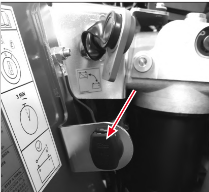
Fig. 138: Prise du véhicule préchauffage
