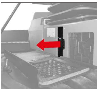
Fig. 326: Filtre du système de climatisation
