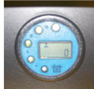
Batterie chargée : Les diodes vertes sont allumées.
