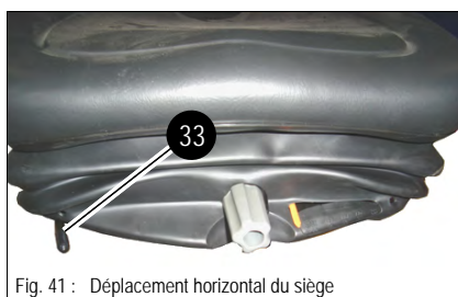
Fig. 41 : Déplacement horizontal du siège
