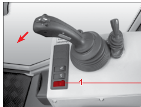
Fig. 76 Abaissement d'urgence de la flèche
