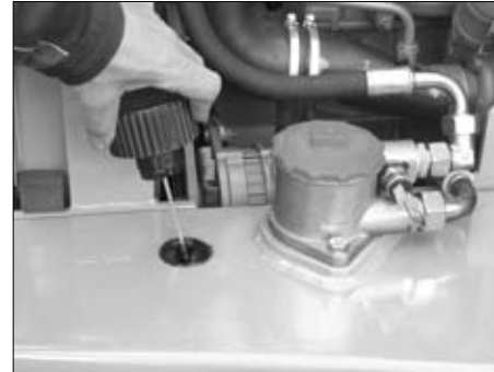
Fig. 77 Purge de la pression résiduelle
