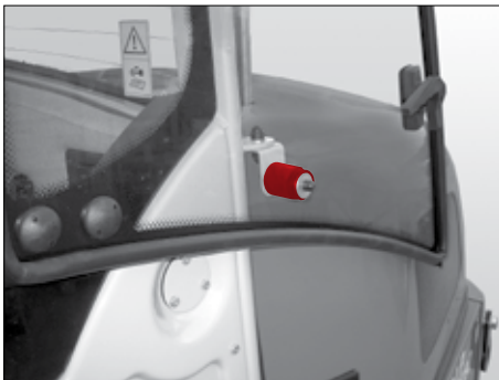
Fig. 23 Blocage de la fenêtre
