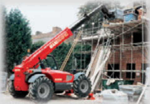
MANUTENTION : Levée/Descente + Sortie/Rentrée du télescope
